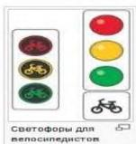
В светофорах применяются световые сигналы зеленого, желтого, красного и бело-лунного цвета. В зависимости от назначения сигналы светофора могут быть круглые, в виде стрелки (стрелок), силуэта пешехода или велосипеда и X-образные. Светофоры с круглыми сигналами могут иметь одну или две дополнительные секции с сигналами в виде зеленой стрелки (стрелок), которые располагаются на уровне зеленого круглого сигнала. Круглые сигналы светофора имеют следующие значения:
